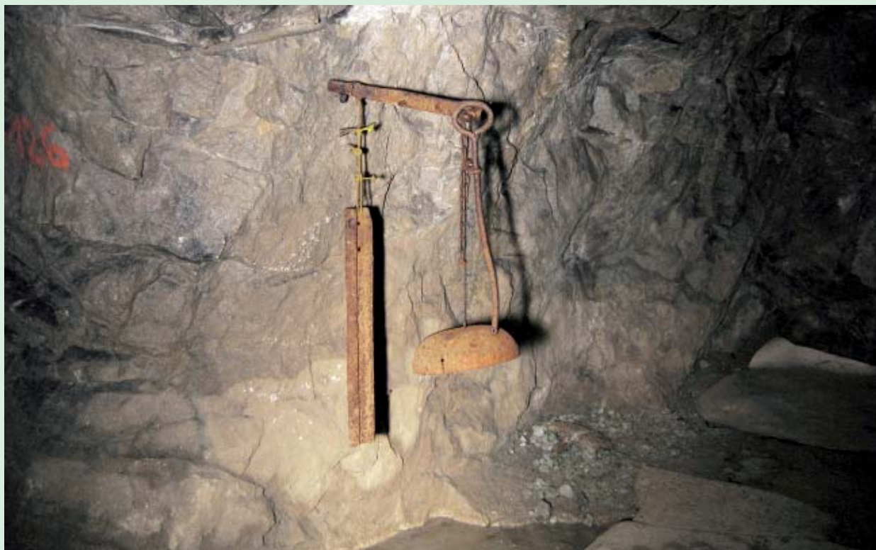
8. „Hagenův gong“ – původně důlní signalizační zařízení v lomu Malá Amerika.
