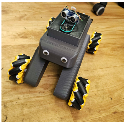
Obrázek 1: Model autonomního vozítka „Sonar Car“ z maturitní práce.
