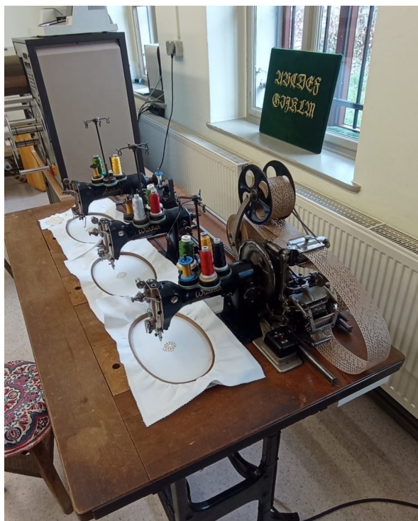
Obrázek 6: Dnešní využití děrných štítků pro výrobu Plavenské krajky
